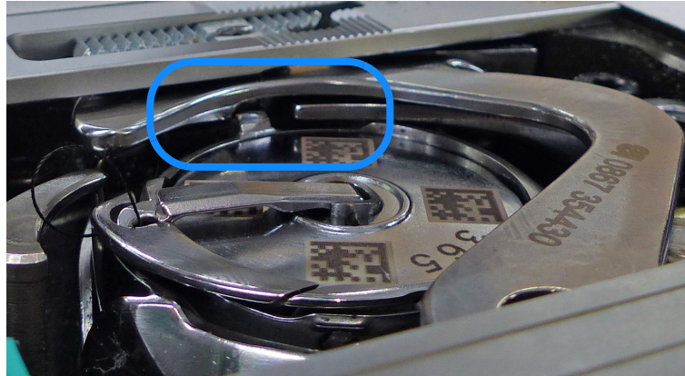
Abb. 26: Stichplatte demontieren und montieren (3)
