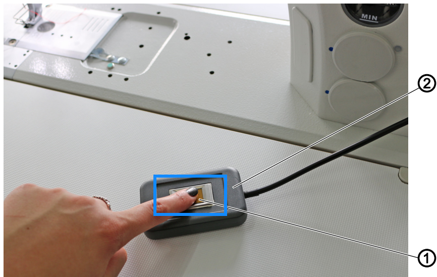
Abb. 126: Mit Fingerprint-Scanner anmelden (2)
