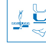
Thread trimming and sewing foot lift, actuated by foot Fadenabschneider u. Nähfußlüftung, fußbetätigt Atacado, alza-prensateles mando por pedal
