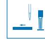
Reflecting light barrier for automatic sewing stop at fabric end Reflexlichtschranke für automatischen Nähstop am Stoffende Final de costura por fotocélula
